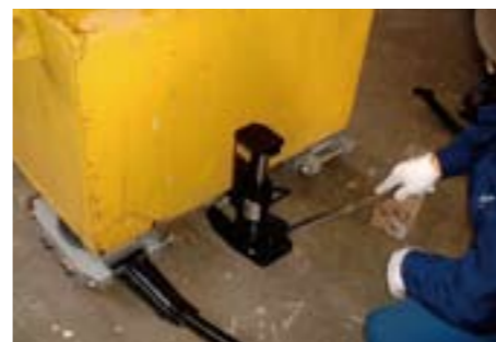
爪付ジャッキの併用で方向転換もスムーズに行えます。
