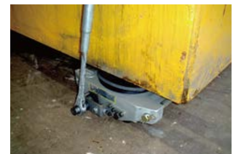
自走式スピードローラーで重量物の搬送作業もらくらく、省力化を実現します。
