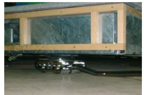
低床型スピードローラーが狭い荷重ポイントにも対応します。
