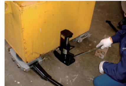
爪付ジャッキの併用で方向転換もスムーズに行えます。
