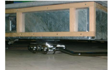
低床型スピードローラーが狭い荷重ポイントにも対応します。
